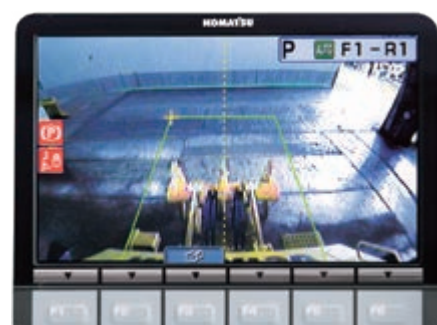
Sistema di telecamera posteriore completamente integrata
