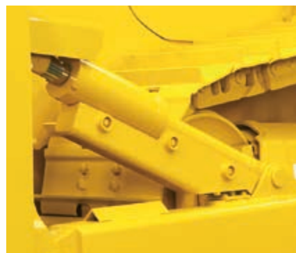
De hydraulische leidingen zijn zoveel mogelijk in de structuren geïntegreerd
