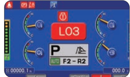
Monitorsystem mit Selbstdiagnosefunktion
