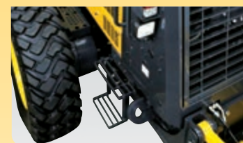
Gezahnte Stufen und Metalllochplatten für einen sicheren Zugang
