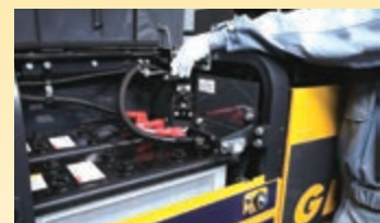
Desconector de batería (bloqueable)
