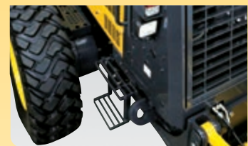
Escalones dentados y suelo de metal perforado para acceder con seguridad
