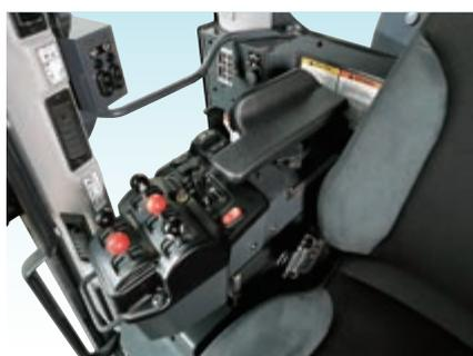
*L'accoudoir dispose d'un réglage électrique de la hauteur*
