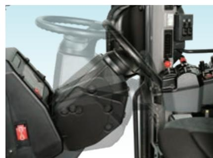
*Réglez le volant à la position la plus confortable*
