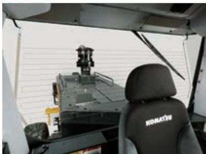
*Le capot moteur bas et étroit offre une vue dégagée sur l'arrière*
