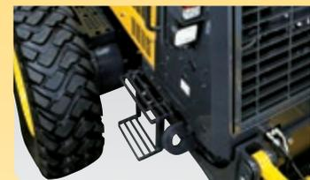
Scalini rigati e pedana in metallo perforato per un accesso sicuro
