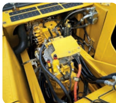
Tecnologia collaudata: componenti del sistema ibrido di Komatsu della quarta generazione
