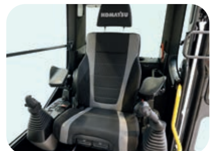
Sedile premium opzionale con ammortizzazione ottimale, regolazione automatica a seconda del peso dell'operatore, supporto lombare, sistema di condizionamento, disponibile con braccioli opzionali multiposizione e leve di comando ergonomiche
