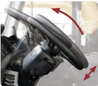
Le volant est réglable horizontalement et verticalement pour trouver la position la plus confortable
