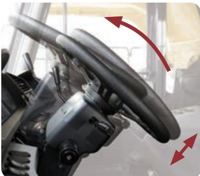
Horizontale und vertikale Verstellung des Lenkrads für eine optimale Sitzposition des Fahrers
