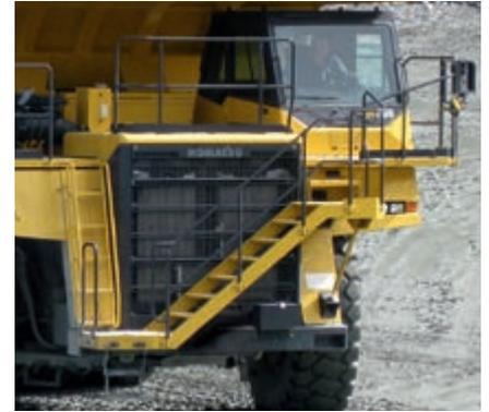
Sicherer Zugang zur Kabine dank der moderaten Steigung der rutschfesten Zugangstreppe mit Handläufen
