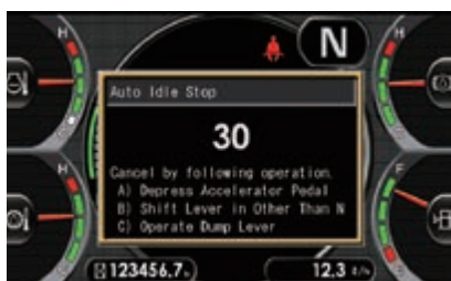
Einstellbare, automatische Leerlaufabschaltung
