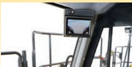
Das separate Display der Rückfahrkamera kann permanent oder nur beim Rückwärtsfahren angeschaltet sein
