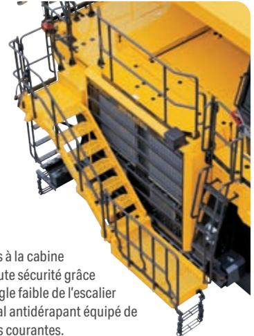
Accès à la cabine en toute sécurité grâce à l'angle faible de l'escalier frontal antidérapant équipé de mains courantes.
