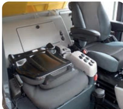
L'instructeur dispose d'un siège à part entière, équipé d'une ceinture de sécurité 2 points à enrouleur automatique
