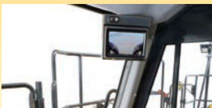
Il monitor retrovisore separato può rimanere sempre acceso (solo durante la retromarcia)
