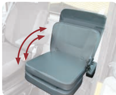
El asiento, de grandes dimensiones, es abatible para facilitar el acceso a la cabina, al filtro del aire acondicionado y a la guantera.
