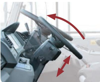
Réglez le volant à la position la plus confortable.
