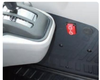
Interrupteur d'arrêt secondaire du moteur
