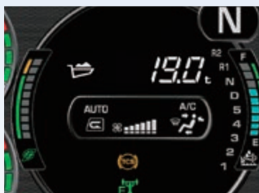
Laadcapaciteitsmeter geeft geladen gewicht weer
