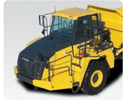
Ingebouwde ROPS/FOPS structuren in overeenstemming met de ISO 3471 en SAE J1040-1988c normen
