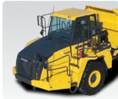
Integrerade ROPS/FOPS enligt standarderna ISO 3471 och SAE J1040-1988c
