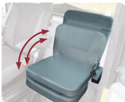
Fullstort elevsäte med sittdyna och ryggstöd som går att fälla ner för att det ska vara lätt att komma in i hytten och komma åt luftkonditioneringsfilter och handskfack
