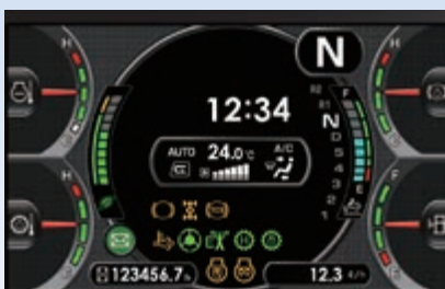
Lättöverskådlig information: LCD-skärm med basinstrumentpanel
