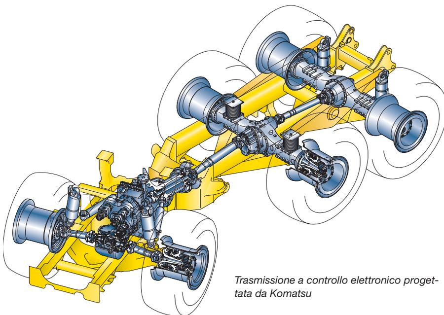
*Trasmissione a controllo elettronico progettata da Komatsu*
