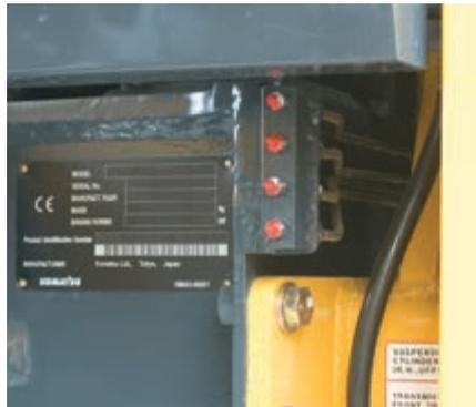
Graissage centralisé à distance
