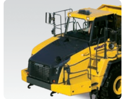
Die integrierten ROPS/FOPS-Strukturen entsprechen den Normen ISO 3471 und SAE J1040-1988c
