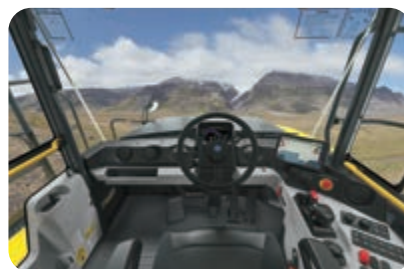
Aumento della superficie vetrata del 16% e riduzione dei punti ciechi del 43% (rispetto al modello HM400-5)
