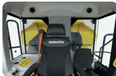
La visibilità posteriore è migliorata grazie all'eliminazione dei montanti posteriori sinistro e destro
