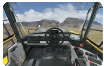
16% större glasyta och 43% minskning av döda vinklar (jämfört med HM400-5)
