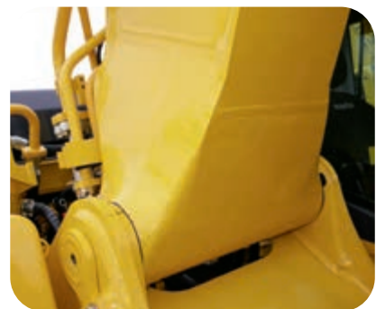
Gegoten giekvoet en giekplaten uit één stuk
