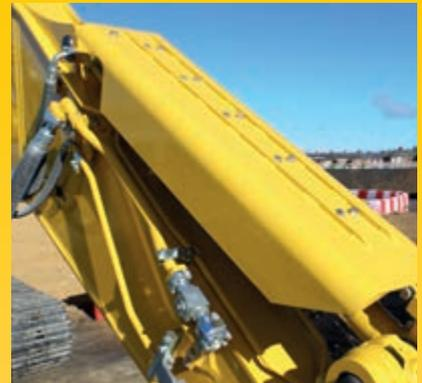
Hydraulikzylinderschutz (optional), verstärkte Löffelaufnahme und weitere Details wie HD-Schutz an den Scheinwerfern sorgen für Rundumschutz der Maschine.
