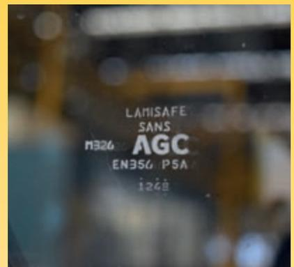
Front- und Dachscheibe aus Verbundsicherheitsglas (gemäß EN356 P5A); Scheibenwisch-/waschanlage für Dachscheibe als Standardausrüstung.
