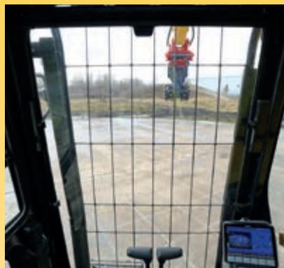
Sorgfältig angepasstes Schutzgitter ermöglicht maximale Sicht und ordnungsgemäßen Schutz; einteiliges Frontschutzgitter und Frontscheibe aus Verbundsicherheitsglas.
