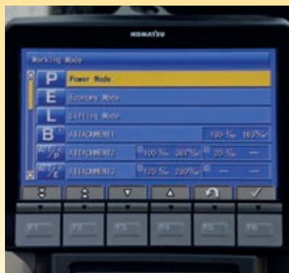
Das integrierte System zur Steuerung von Hydraulikölstrom und -druck für Anbaugeräte speichert Voreinstellungen für bis zu 15 Anbaugeräte und stellt sicher, dass diese mit maximaler Effizienz eingesetzt werden können.
