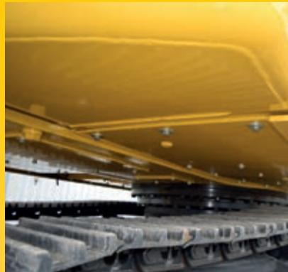
HD-Bauchschutz (9 mm) unter dem ganzen Oberwagen für erhöhten Schutz vor Beschädigungen durch Material am Boden.
