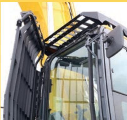
Klappbares FOPS-Frontschutzgitter für einfache Reinigung der Scheibe; Demolition Safety SpaceCab™-Abbruchkabine mit ROPS gemäß ISO 12117.2:2008.
