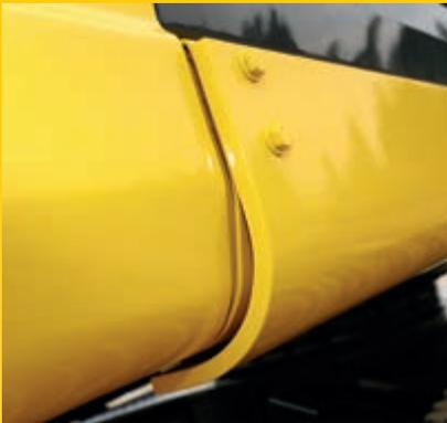
Gebogene seitliche Panzerbleche (15 mm), geschraubte Ausführung, zum optimalen Schutz vor Beschädigungen von unten oder von den Seiten.
