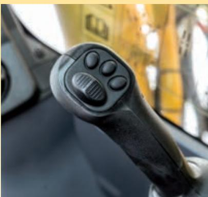
Joysticks mit Proportionalsteuerung für Anbaugeräte.
