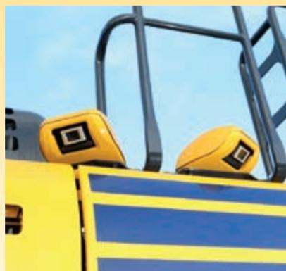
La visibilité obtenue grâce à KomVision offre en permanence à l'opérateur une vue claire de la zone de sécurité autour de la machine. Cela permet à l'opérateur de se concentrer sur le travail en cours, même par faible luminosité.
