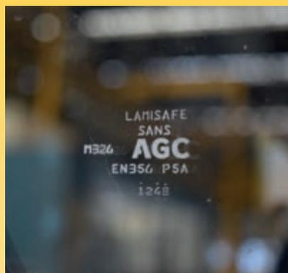
Le pare-brise et le hayon de toit sont équipés de verre de sécurité (conforme à la norme EN356 classe P5A). Le système de nettoyage/essuyage du hayon de toit est prévu de série.
