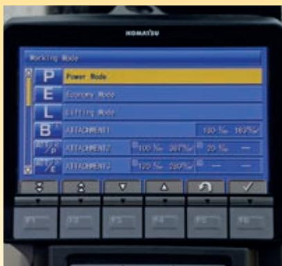
Le système intégré de contrôle des pressions et des débits d'huile pour les accessoires permet jusqu'à 15 présélections et garantit une utilisation optimale des outils.
