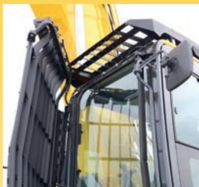
La protection avant sur charnière offre un accès aisé pour le nettoyage du pare-brise. La cabine Safety SpaceCab™ de démolition est certifiée ROPS conformément à la norme ISO 12117-2:2008.
