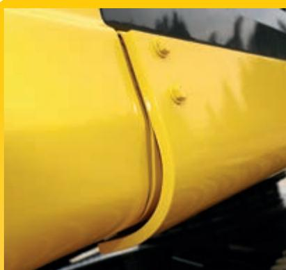
Protections latérales de tourelles usage sévère (15 mm) boulonnées de chaque côté de la tourelle, offrant une protection contre les débris au sol ou contre les chocs latéraux.
