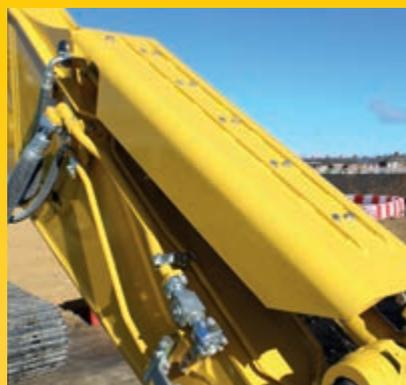
La protection de vérin de godet (en option), la timonerie renforcée et des détails tels que la protection résistante du phare de flèche complètent la protection générale.
