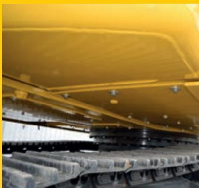
Le dessous de la tourelle est entièrement enveloppé de protections usage sévère sous tourelle (9 mm) pour une meilleure protection contre les débris au sol.
