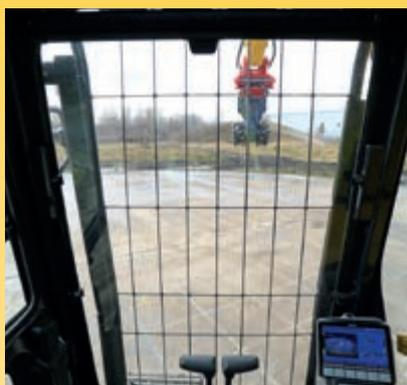
La grille avant soigneusement alignée assure une visibilité maximale avec une protection adéquate. Le pare-brise en une pièce est réalisé en verre de sécurité.
