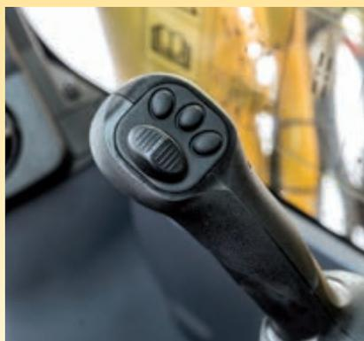
Manipulateurs avec boutons de commande proportionnels pour les accessoires.
