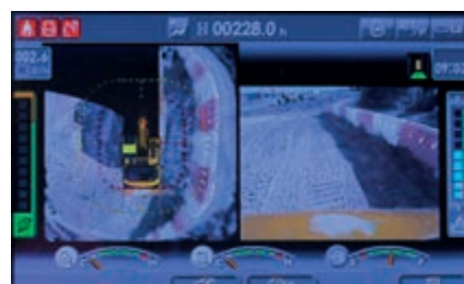
KomVision zeigt zusätzlich zu den verschiedenen Kameraansichten eine permanent verfügbare Draufsicht („Birdview“) an
