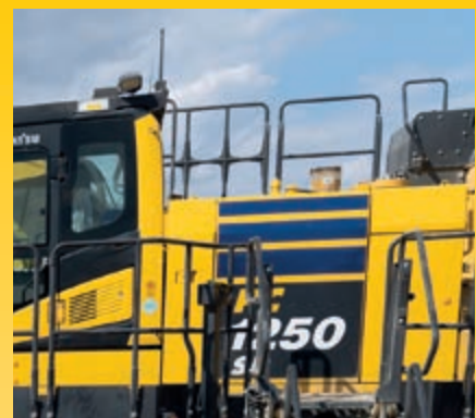
Handläufe und rutschfeste Oberflächen
