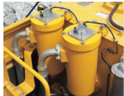
Verschmutzungsanzeige in den Filtern in der Rücklaufleitung hilft, Störungen des Hydrauliksystems zu vermeiden.
