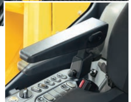
Armstütze mit einfacher Höhenverstellung
