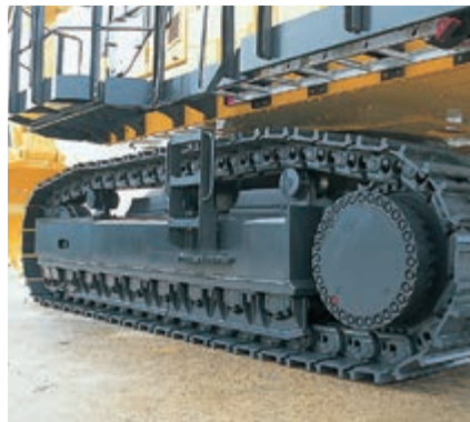
Laufrollenschutz über die gesamte Laufwerkklänge (Option)
