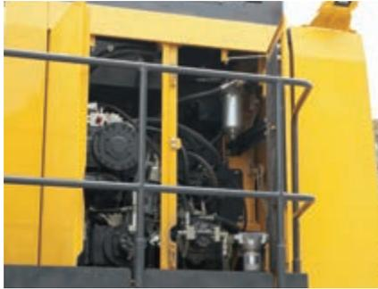
Une large passerelle éclairée offre un accès aisé aux points d'inspection et de maintenance. De plus, les points de maintenance sont regroupés pour faciliter les inspections du moteur et des composants hydrauliques.
