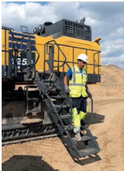
Pour accéder à la cabine et en sortir, un escalier à entraînement hydraulique est prévu de série.
