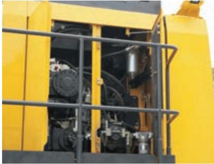
Un'ampia passerella centrale illuminata assicura un facile accesso ai principali punti di controllo e manutenzione. Inoltre, i punti di controllo e manutenzione sono raggruppati per facilitare e velocizzare i controlli al motore e ai componenti idraulici.
