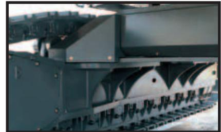
**Robuste Schutzvorrichtungen** für die Rohrleitungen gegen Beschädigung durch Felsgestein.
