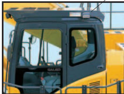
Die **zeitgesteuerte Stufenbeleuchtung** leuchtet für ca. 2 Minuten, damit der Fahrer sicher die Maschine verlassen kann.
