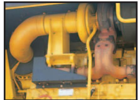
Für alle Motorteile mit **hoher Temperatur** und für den Nebenantrieb wurde ein Überhitzungsschutz eingebaut.
