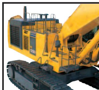
**Große Handläufe und breite Trittstege** rund um den Drehwerksrahmen sichern den bequemen Zugang zu allen Motor- und Hydraulikkomponenten.
