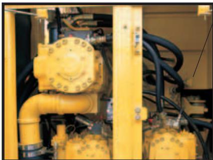
La **séparation moteur / pompe** permet d'éviter que de l'huile ne soit projetée sur le moteur en cas d'éclatement d'un tuyau hydraulique.
