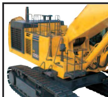
De **grandes mains courantes et passerelles** sont prévues autour du châssis tournant pour un accès plus sûr et plus aisé au moteur et aux composants hydrauliques.
