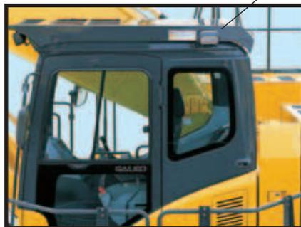
La **lumière avec minuterie** offre automatiquement deux minutes de lumière pour permettre à l'opérateur de descendre de la machine en toute sécurité.
