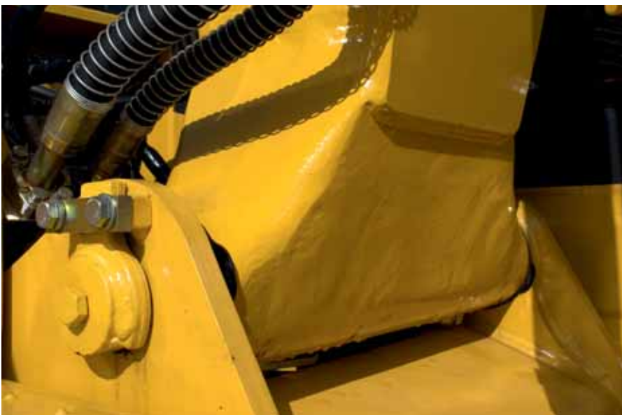
Auslegerfuß aus Stahlguss
