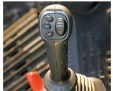
Joysticks mit Proportionalsteuerung für Anbaugeräte
