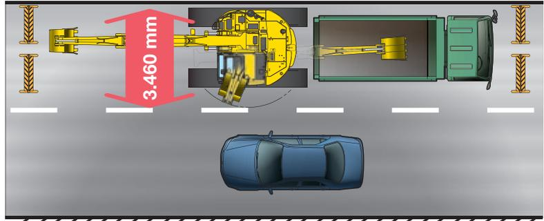
Lors de travaux routiers, le déport de la machine sur la bande non occupée de la chaussée est limité au minimum pour les phases de rotation de la tourelle. Cela permet de positionner un camion à benne basculante tout près des chaînes de la machine.
