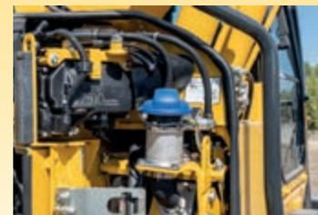
Pour faciliter l'accès au réservoir d'AdBlue®, celui-ci est installé sur l'escalier avant.
