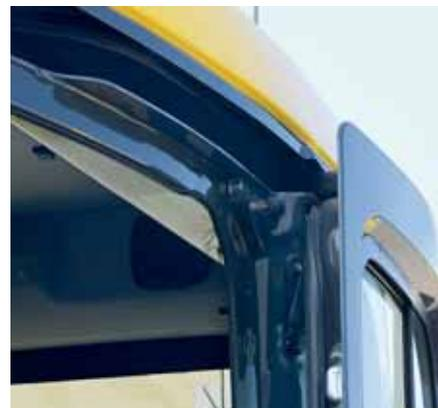
Die Schiebetür ist der abgerundeten Kabinenform angepasst und somit perfekt gegen Beschädigungen geschützt. Sie ist weiterhin mit einem Schiebefenster ausgestattet.
