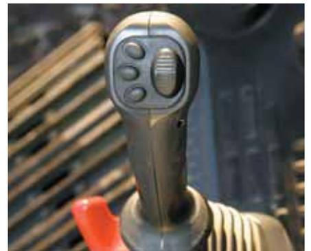
Joysticks mit Proportionalsteuerung für Anbaugeräte
