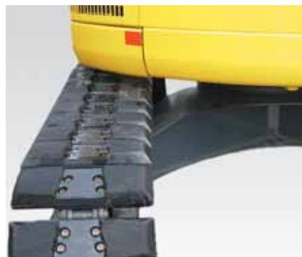
500 mm Gummibodenplatten (Roadliner) (optional)
