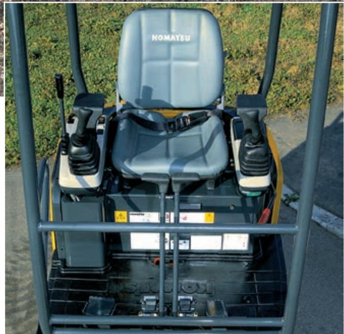
Le bouton d'interrupteur de vitesse (en option) se trouve sur le panneau où l'opérateur peut contrôler en permanence toutes les fonctions de la machine.
