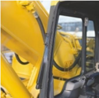
Der Überblick nach vorne wird weiterhin durch die Verwendung von Komatus patentiertem Scheibenwischer-system verbessert. Wird der Scheibenwischer nicht gebraucht, ruht er im Kabinenrahmen selbst, ohne irgendeinen Kontakt mit der Frontscheibe. Dieses System bietet neben einem ausgezeichneten Überblick zugleich eine Abschaltung des Scheibenwischers, bevor die Frontscheibe angehoben wird.
