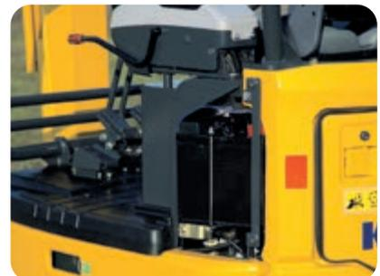
Linke Wartungsklappe: leichter Zugang zur Batterie
