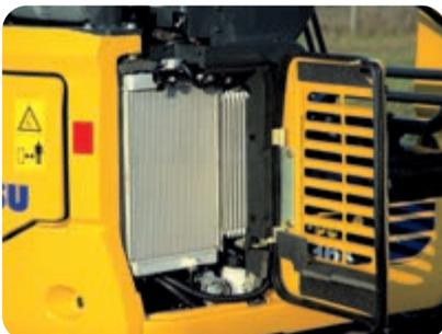
Rechte Wartungsklappe: einfacher Wartungszugang und leichte Reinigung der Kühler
