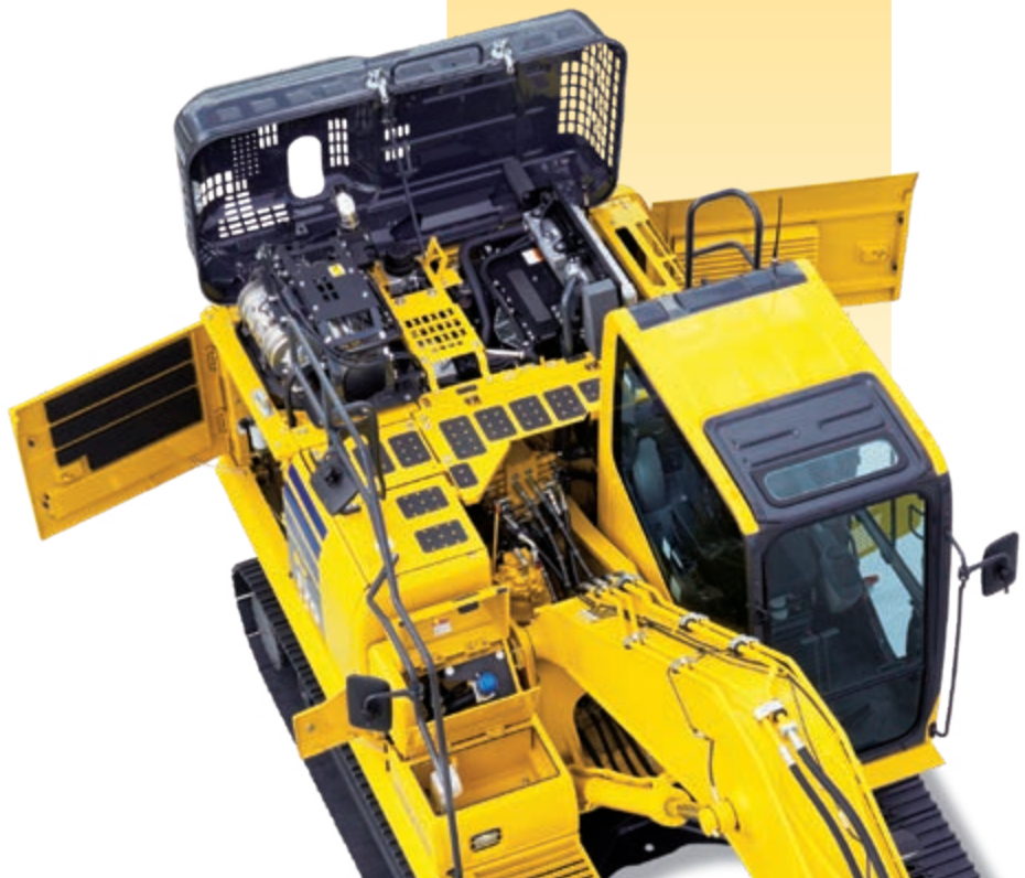
Para facilitar el acceso, el depósito AdBlue® se encuentra instalado en la escalera delantera
