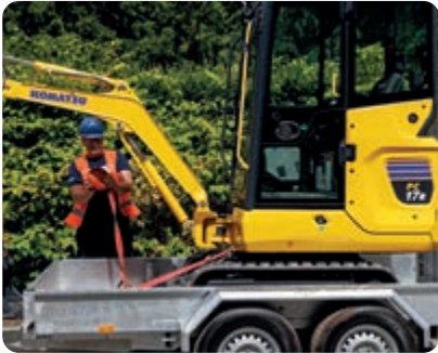
Verzurrösen am Oberwagen ermöglichen eine schnelle Transportsicherung
