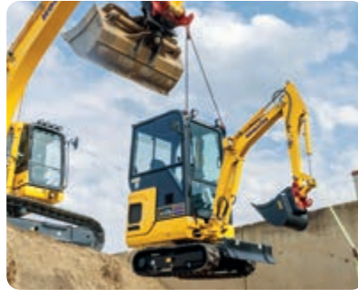
Schnelles und einfaches Anheben mit Seilen möglich, keine zusätzlichen Werkzeuge erforderlich
