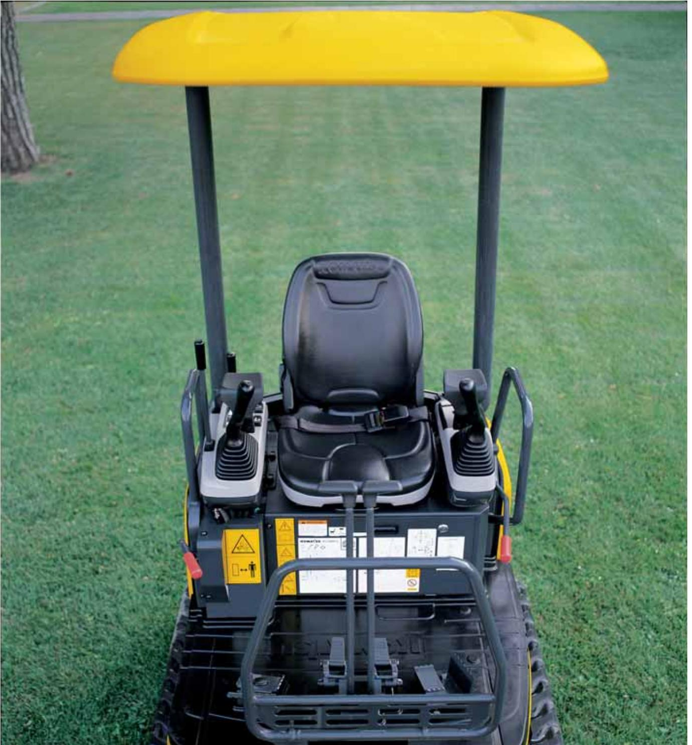
Das sorgfältig und bis ins kleinste Detail durchdachte Fahrerhaus bietet dem Fahrer maximalen Komfort und optimale Sicht. Der Zugang ist sowohl bei der Ausrüstung mit Wetterschutzdach als auch bei der Kabine mit Schiebetüren bequem und sicher. Der einstellbare Fahrersitz, ergonomisch angeordnete PPC-Bedienelemente und ein freier Fußraum ermöglichen auch großen Fahrern ein angenehmes Arbeiten. Die Fahrstufenwahl erfolgt über einen Schalter am gut ablesbaren Monitorsystem.
