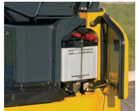
Linke Wartungsklappe: leichter Zugang zur Batterie
