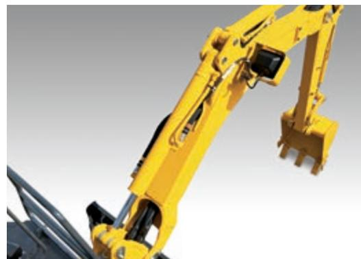
*Il cilindro del primo braccio è ora montato sulla parte superiore. Questo aiuta a evitare di colpirlo contro gli ostacoli quando si carica un camion o si scava in profondità. Il suo design aumenta anche la forza di pressione del braccio, migliorando la penetrazione nel terreno.*
