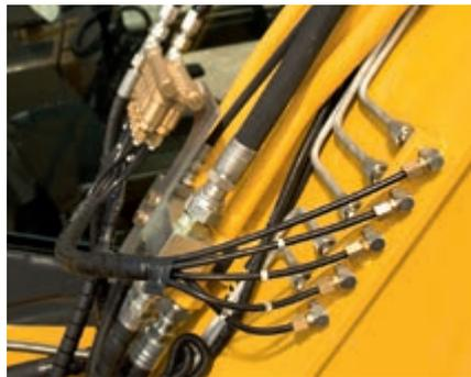
Automatische Zentralschmieranlage (optional)
