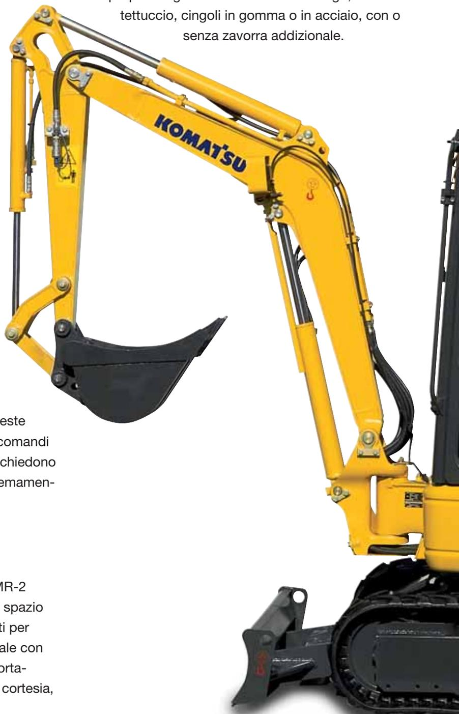
Inoltre, la linea idraulica ausiliaria, a 1 o 2 vie, permette di utilizzare molteplici attrezzature, quali ad esempio il martello, la benna mordente, la trivella, etc.
