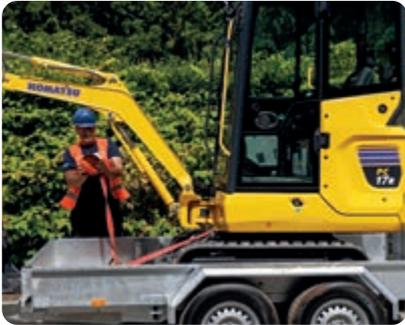
Verzurrösen am Oberwagen ermöglichen eine schnelle Transportsicherung
