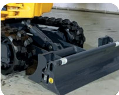
Verstellbares Laufwerk mit klappbarem Schild
