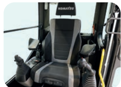
Optionaler Premium-Fahrersitz mit hochwertigen Kissen, automatischer Gewichts Anpassung, Lendenwirbelsäulenstütze, Klimaautomatik, verfügbar auch mit optionalen verstellbaren Armstützen und ergonomischen Bedienhebeln
