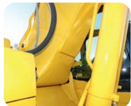
Gegoten giekvoet en giekplaten uit één stuk
