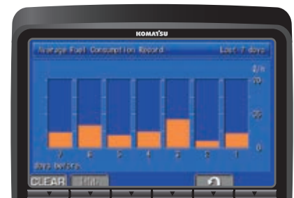
Übersicht über Eco-Anzeigen
